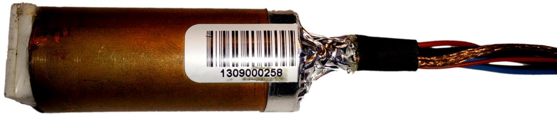
Abbildung 7.4.: APD-Vorverstärker-Einheit mit elektr. Isolation, Verkabelung und Barcode-Aufkleber.
