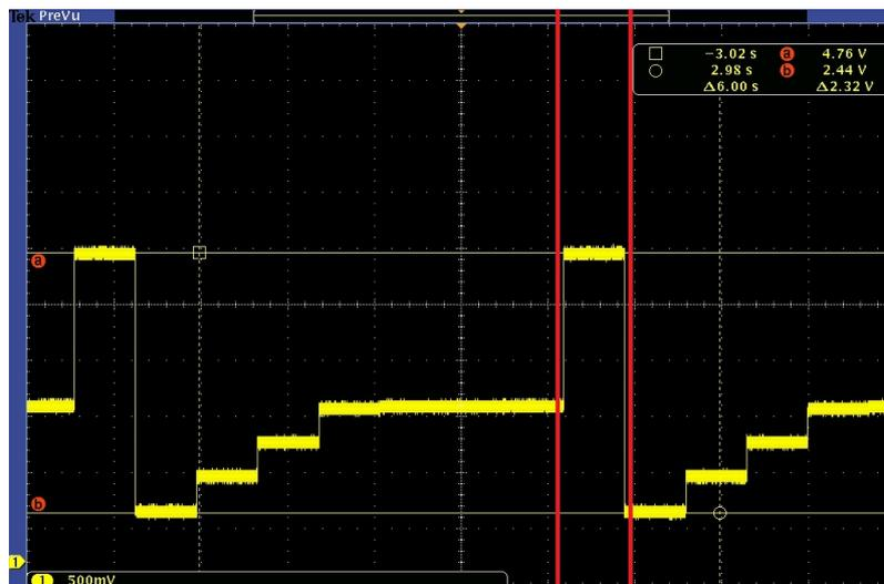
Abb. 9.8: Ausgangsspannungen des Instrumentenverstärkers bei unterschiedlichen Eingangsspannungen. Rot markierter Bereich: Ausgangsspannung, wenn Eingangsspannung außerhalb des spezifizierten Bereichs liegt.
