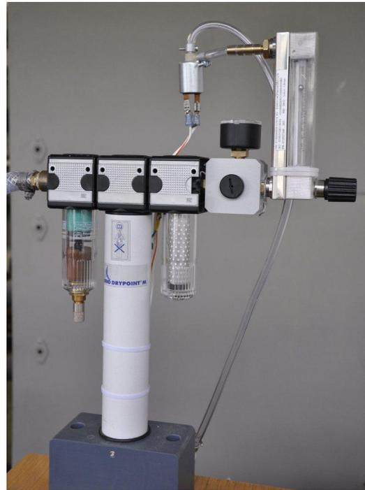
Abb. 8.2: Aufbau zur Aufbereitung der Druckluft. Von links nach rechts: Mikrofilter, Membran-Drucklufttrockner, Feinstfilter, Druckminderer, Durchflussmesser mit nachgeschaltetem Magnetventil.
