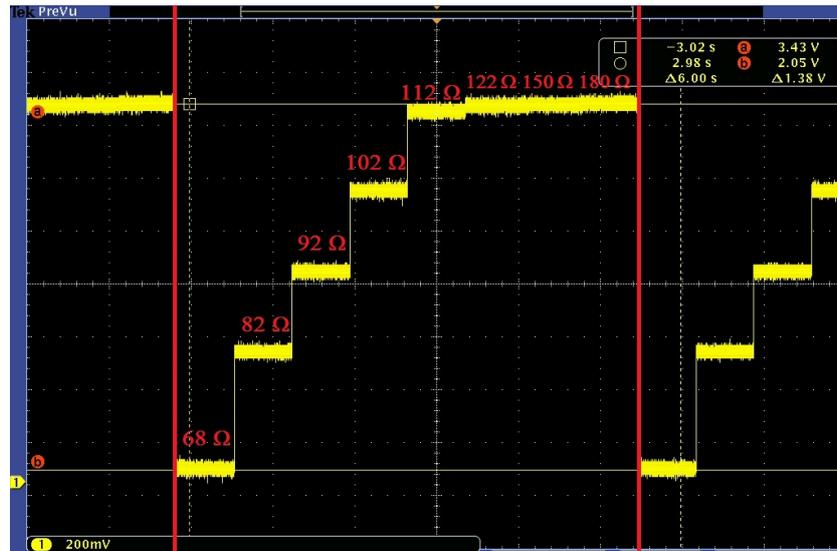
Abb. 9.10: Spannung am Ausgang der acht Instrumentenverstärker mit zugeordnetem Widerstand am jeweiligen Steckplatz der Huckepackplatine
