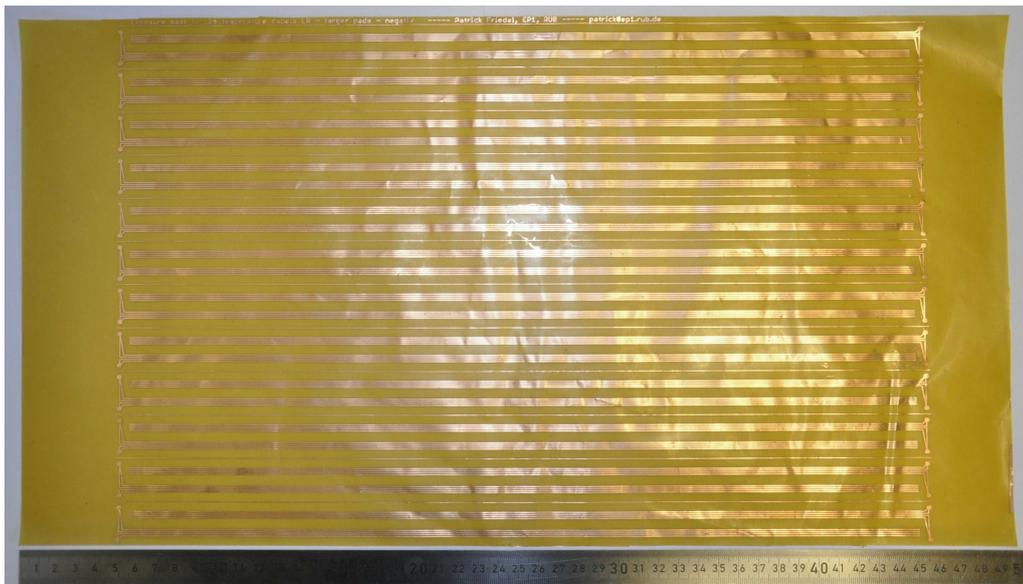
Abb. 7.12: Polyimid-Kupferfolie nach dem Ätzprozess
