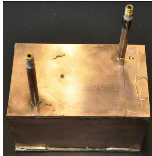
Abb. 8.3: Aufbau zur Temperierung des aufbereiteten Gases. Im Bad des Kälte-Umwälzthermostaten (links) befindet sich der rechts dargestellte Kupferbehälter, durch den das Gas strömt und wo die Temperatur des Gases sich an die Kühlmitteltemperatur angleicht.
