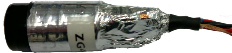
Abbildung 4.23: VPTT-Vorverstärker-Einheit ummantelt mit Elastosil, Kupfer und Aluminiumklebestreifen.
