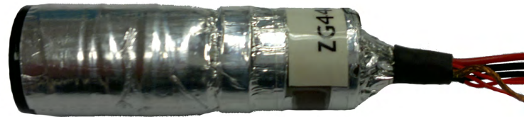
Abbildung 4.20: VPTT-Vorverstärker-Einheit mit Schirmung aus Kupferrohr und darüber geklebtem, leitendem Aluminiumklebeband.
