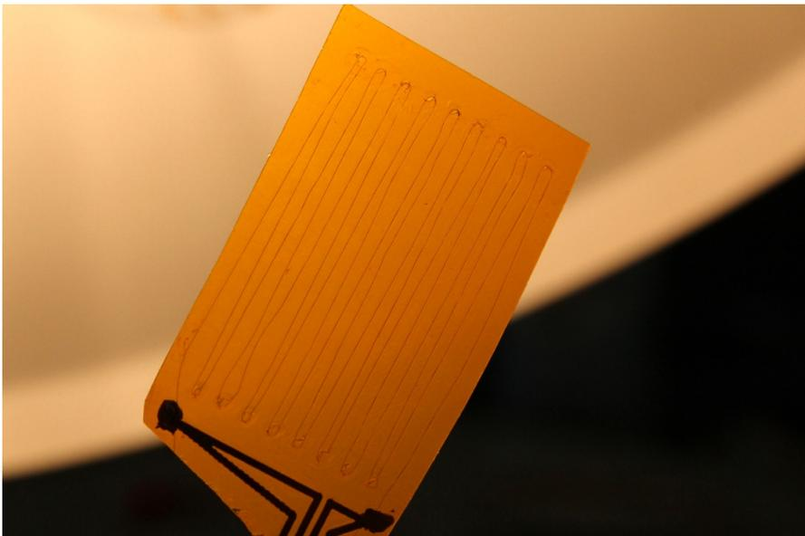
Abb. 13.9: Ansicht eines selbst gebauten thinPT zur Temperaturmessung.
