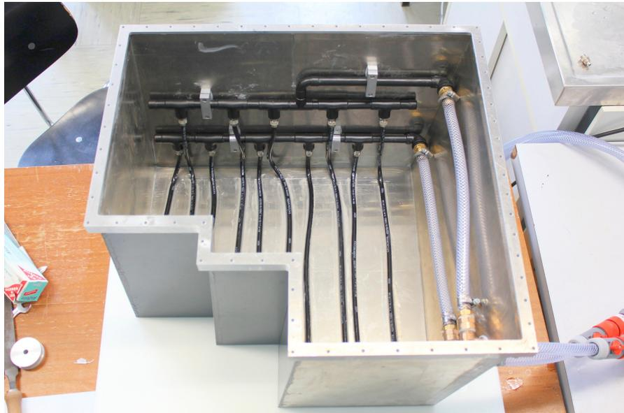
Abb. 13.8: Blick in die Fronthülle mit der Frontkühlung. Die PU-Schläuche wurden fest an die Frontfläche geklebt. Das Verteilersystem befindet sich unterhalb der Oberseite der Fronthülle. Die Zu- und Ableitung erfolgt durch die Seite der Fronthülle.
