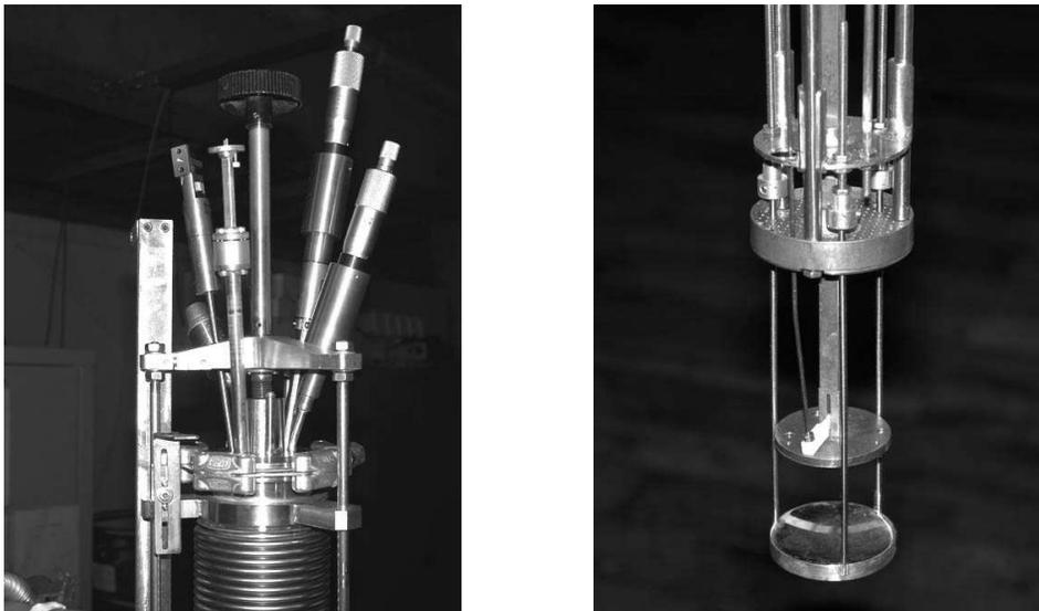
**Abbildung 4.7:** Linkes Bild: Kopf des ESR-Einsatzes (von rechts: Mikrometertrieb für den Hohlspiegel, Mikrometertrieb für den Koppelstift, Höhenverstellung für den gesamten Einsatz, Mikrowellenleiter mit Vakuumdichtung). Rechtes Bild: Die Variation des Spiegelabstandes erfolgt mit Hilfe der über den Mikrometertrieb bewegbaren Messingscheibe im Bild ganz oben.
