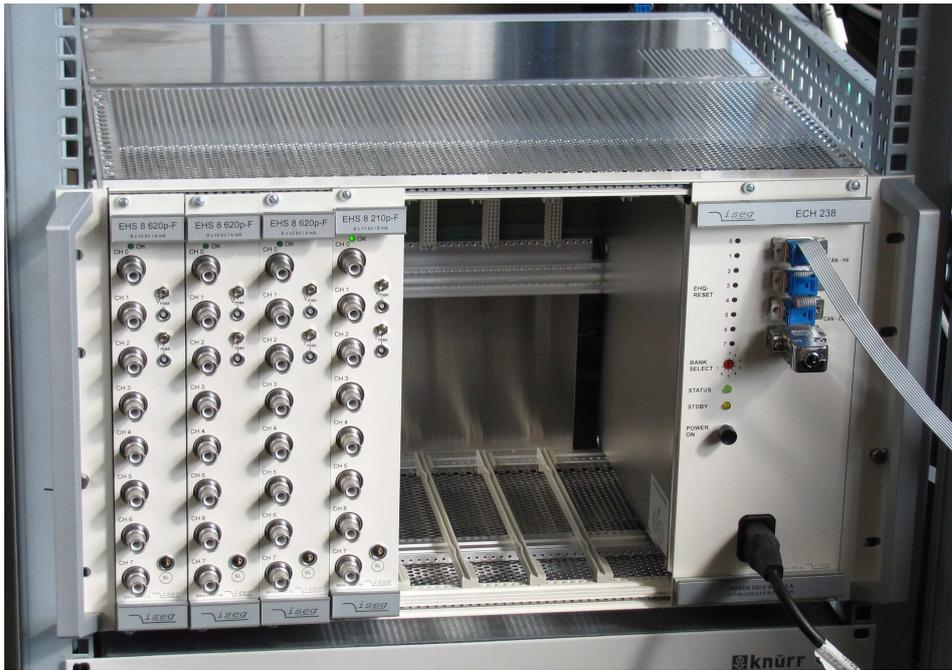
Abbildung 11.5: Hochspannungsversorgung von ISEG. Rechts im Crate ist der Crate Controller mit angeschlossenem CAN-Bus zu sehen. Links sind vier Module eingesetzt
