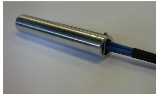
Abbildung 9.5: kleine Lichtfaserhülse mit Klebepunkt und Schrumpfschlauch (links), große Lichtfaserhalterung von hinten mit Lichtfasern im Schrumpfschlauch (rechts)
