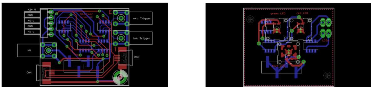
Abbildung 8.17: Zweilagige Platine mit den LEDs (links), zweilagige Platine mit den Steckern (rechts). Lage 1 (rot), Lage 2 (blau), Durchführungen (grün)
