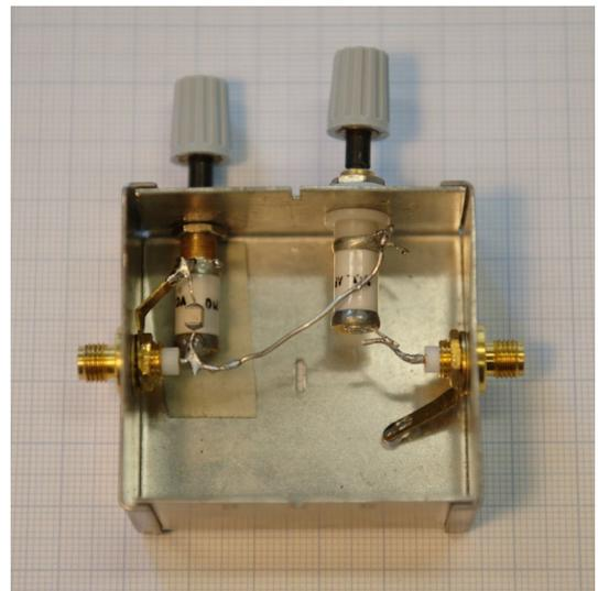
**Abb. 3.2** Die geöffnete Match- und Tune-Box. Links die Abstimmkapazität aus Trimmer und Keramikkondensator, rechts der Trimmer zur Anpassung.
