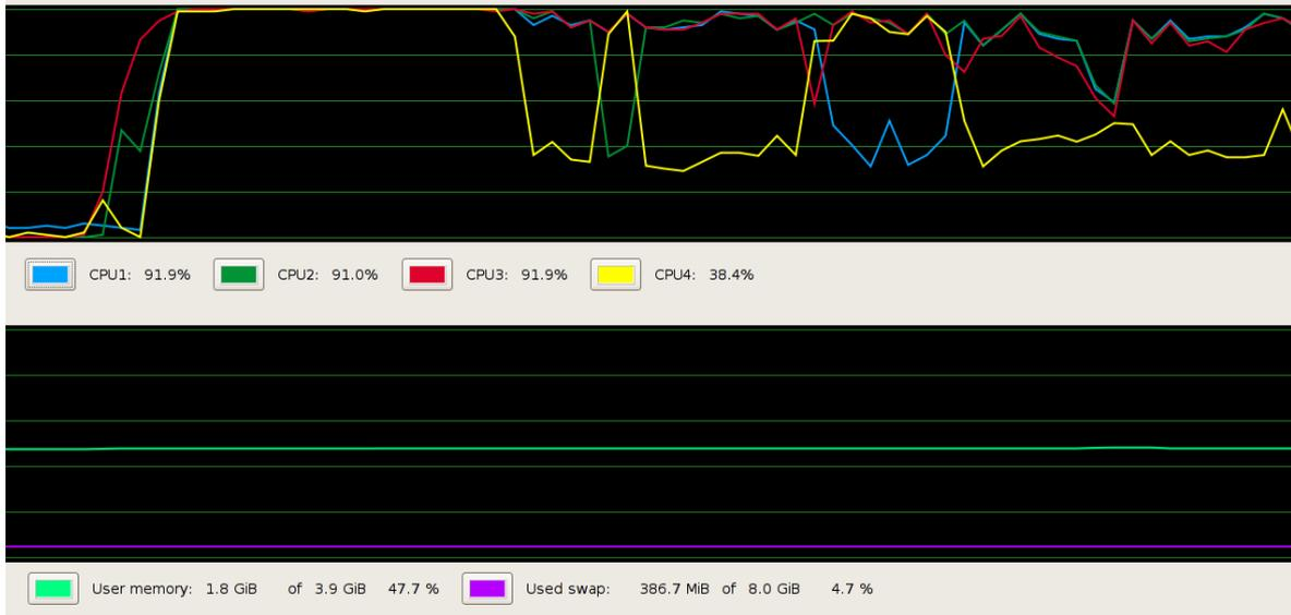
Abbildung 6.9: Zeitlicher Verlauf der Auslastung eines Mehrkern-Prozessors (4 Kerne) und des Arbeitsspeichers beim Start der Kalibrierung mit einer lokalen Datenbank. Der Start erfolgte im Moment des Anstiegs der Prozessorauslastung. Der gesamte Bildbereich erstreckt sich über ca. 10 min.
