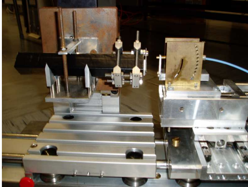
Abbildung 4.4: Die Messapparatur mit Kristall-, APD- und Glasfaserhalterung, sowie den Schrittmotoren
