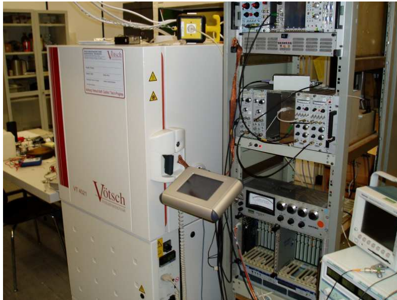
Abbildung 4.2: Der Messplatz mit Rack (rechts) und Klimagerät (links)
