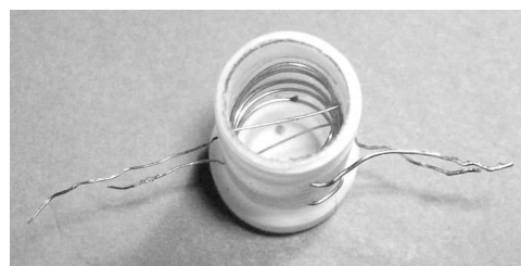
Abbildung 5.8: Der Probenbehälter mit den zwei NMR-Spulen; links die einzelne Windung für die Protonen-NMR, rechts die innenliegende fünfwindige Spule für die ^{13}\text{C} -NMR.
