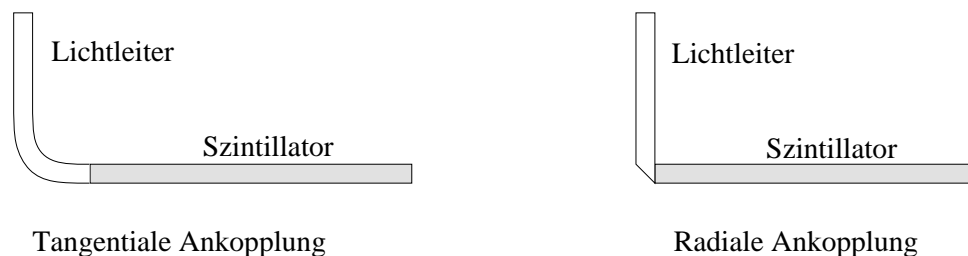
Abb. 4.22: Eine tangentielle Ankopplung der Lichtleiter ist aus Platzgründen nicht möglich. Darum muß das Licht um 90^\circ umgelenkt werden
