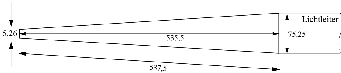
Abb. 3.1: Maße des Szintillatorstreifens in Millimeter
